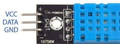
Figure 3. DHT-11 sensor
